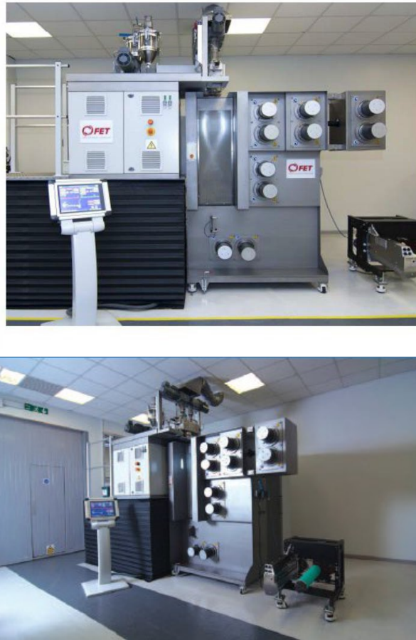
Gambar 3.6 Modul utama mesin melt-spinning
