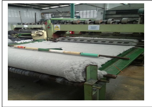
Gambar 3.8 Proses pembuatan kain non woven geotekstil
