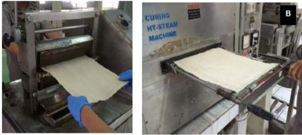
Gambar 3.2 Proses finishing kain dengan metode pad-dry-cure: a) Paddingsqueezing ; b) Drying-curing
