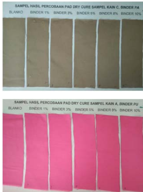
Gambar 3.4 Kain Terimmobilisasi Nanopartikel Zno Dengan Proses Pad Dry Cure Menggunakan Binder Poliakrilat (Pa) Dan Poliurethan (Pu)
