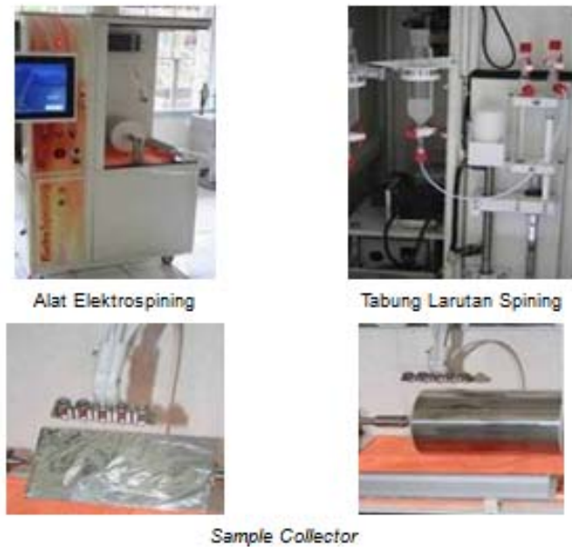
Gambar 3.1 Skema Proses Elektrosponing
