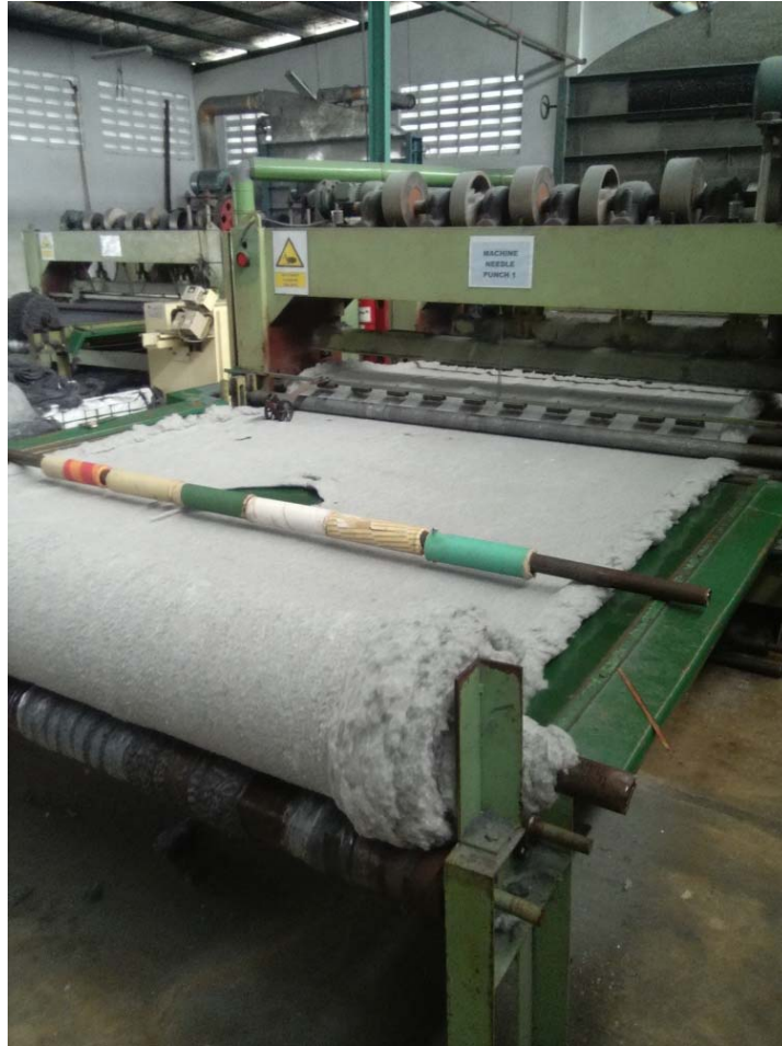
Gambar 3.10 Proses Pembuatan Kain Non Woven Geotekstil di PT Rekadaya Multi Adiprima
